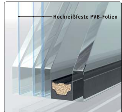
Durchbruchhemmende Verglasung der Klasse P6B nach DIN EN 356
